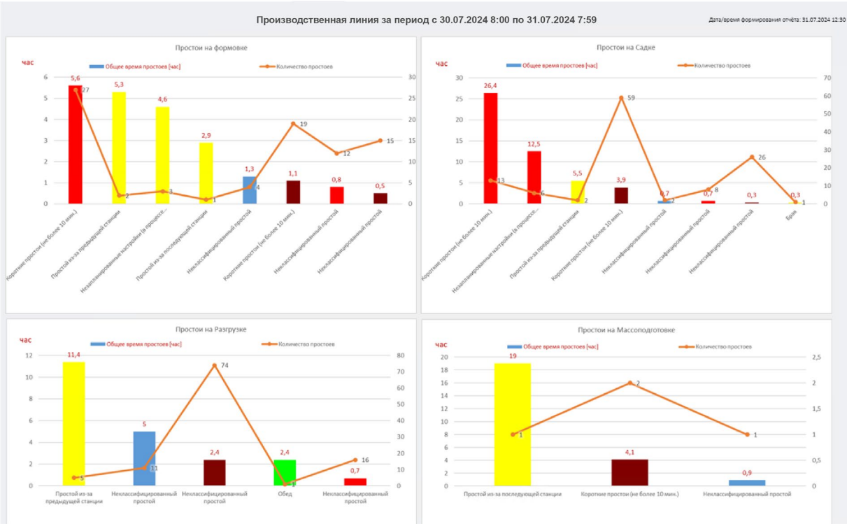
Пример шаблона суточного отчета по простоям в виде диаграмм по основному оборудованию
