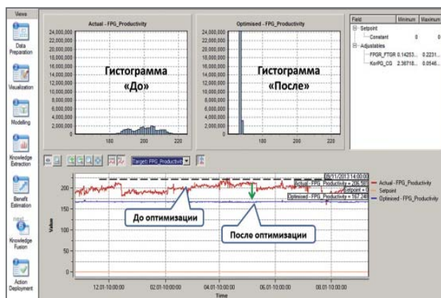
Оптимизация удельного потребления природного газа в печи металлization окатышей
