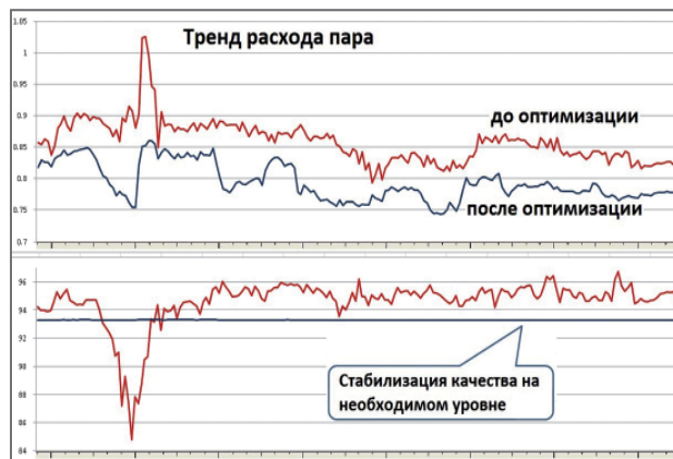
Минимизация потребления пара и стабилизация качества продукции в колонне получения бутадиена
